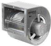
128 CJBD/EC/ALS Keskipakopuhaltimet alumiiniprofiilista ja kaksinkertaisella eristyskerroksella kotelossa integroidulla ohjauselektronikalla varustetulla IE4-hyötysuhdeluokan EC-moottorilla
