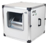
142 CRL/EC Keskipaineiset, yhdeltä puolelta imevät suorakäyttöiset keskipakopuhaltimet taaksepäin kaartuva siipisellä siipipyörällä sekä IE5-hyötysuhdeluokan EC-moottorilla
